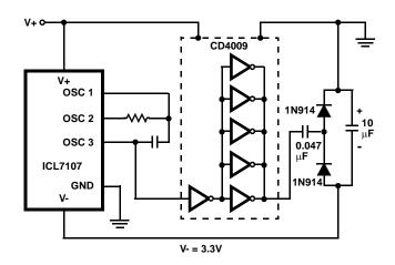
FIGURE 10. GENERATING NEGATIVE SUPPLY FROM +5V
