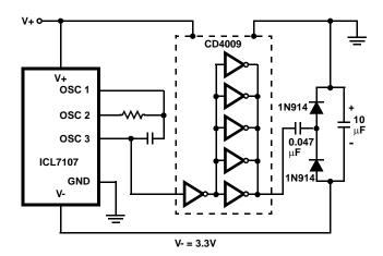
FIGURE 10. GENERATING NEGATIVE SUPPLY FROM +5V
