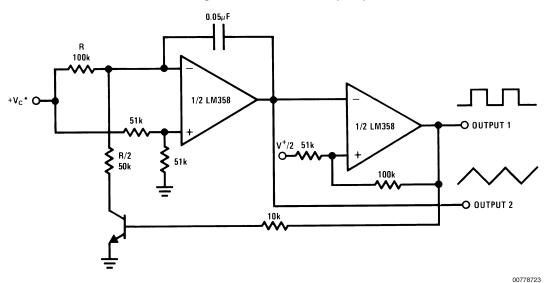
\*WIDE CONTROL VOLTAGE RANGE: 0  $V_{DC} \le V_C \le 2$  (V+ -1.5V  $_{DC}$ )
