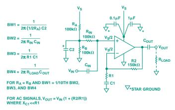
TO MINIMIZE INPUT BIAS CURRENT ERRORS, R2 SHOULD EQUAL  $\rm R_{IN}$  + (1/2  $\rm R_{A}).$
