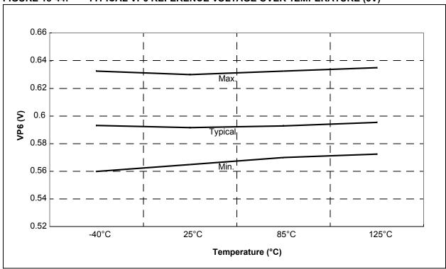
FIGURE 18-45: TYPICAL VP6 REFERENCE VOLTAGE OVER TEMPERATURE (5V)
