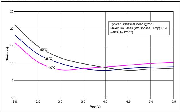
FIGURE 18-38: MINIMUM HFINTOSC START-UP TIMES vs. VDD OVER TEMPERATURE
