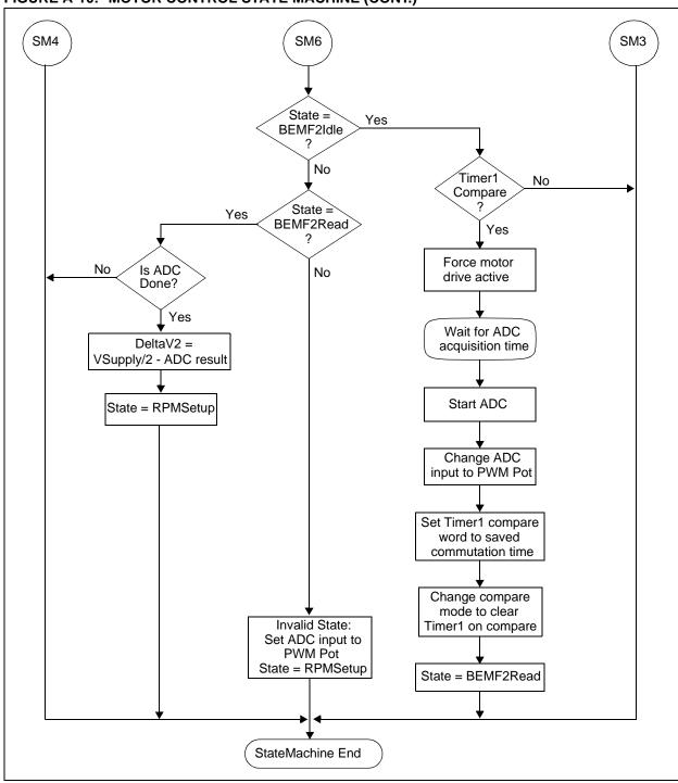
FIGURE A-10: MOTOR CONTROL STATE MACHINE (CONT.)
