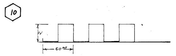
INVERTER STAGE - THIS IS THE OUTPUT OF THE INVERTER STAGE Q5 AND INVERTS THE SQUARE WAVE DRIVING Q8.
