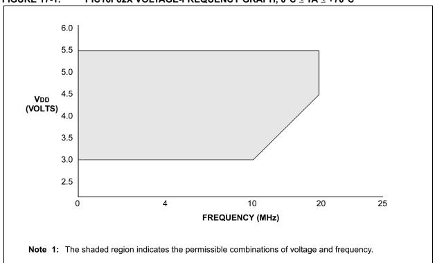
FIGURE 17-2: PIC16F62X VOLTAGE-FREQUENCY GRAPH,  $-40^{\circ}\text{C} \le \text{TA} < 0^{\circ}\text{C}$ ,  $+70^{\circ}\text{C} < \text{TA} \le 85^{\circ}\text{C}$
