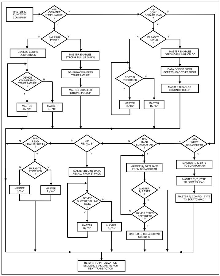
Figure 12. DS18B20 Function Commands Flowchart
