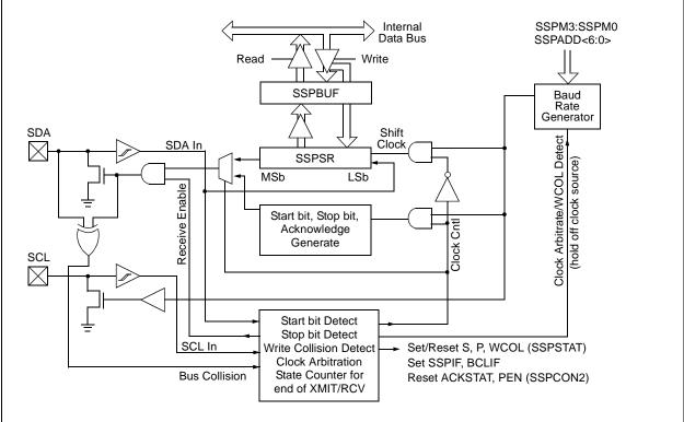
MSSP BLOCK DIAGRAM (I<sup>2</sup>C<sup>™</sup> MASTER MODE)
