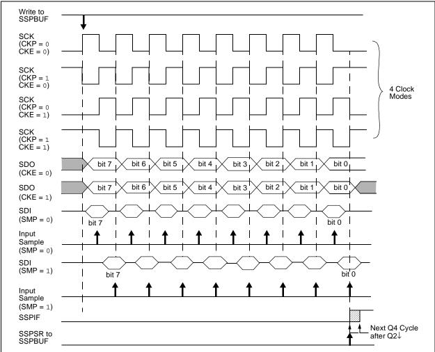
FIGURE 10-3: SPI™ MODE WAVEFORM (MASTER MODE)
