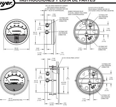
(El tapón de goma no es usado en los modelos sobre 180 pulgadas de presión de agua, modelos de presión media o alta, o en instrumentos que requieren un elastizado en cualquier otro material que no sea silicona para el diafragma.)
