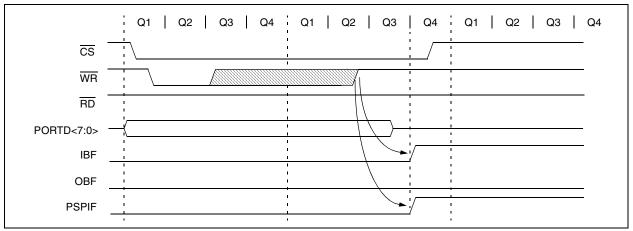
FIGURE 10-4: PARALLEL SLAVE PORT READ WAVEFORMS
