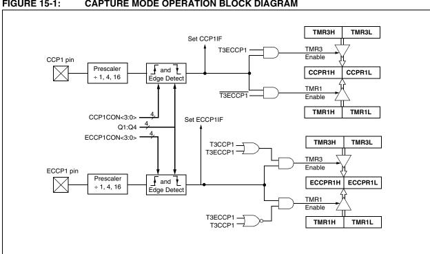
**FIGURE 15-1: CAPTURE MODE OPERATION BLOCK DIAGRAM**
