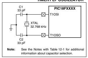
TABLE 12-1: CAPACITOR SELECTION FOR THE TIMER OSCILLATOR<sup>(1-4)</sup>
