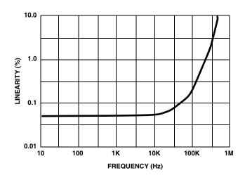
FIGURE 18. TRIANGLE WAVE LINEARITY vs FREQUENCY
