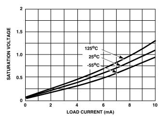
FIGURE 15. SQUARE WAVE SATURATION VOLTAGE vs LOAD CURRENT
