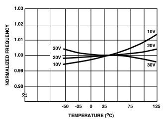
FIGURE 13. FREQUENCY vs TEMPERATURE
