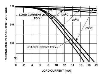
FIGURE 16. TRIANGLE WAVE OUTPUT VOLTAGE vs LOAD CURRENT
