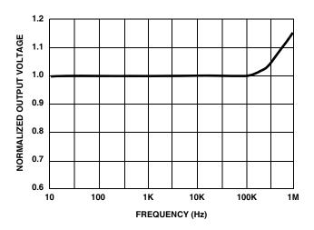
FIGURE 17. TRIANGLE WAVE OUTPUT VOLTAGE vs FREQUENCY
