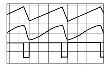
FIGURE 2B. SQUARE WAVE DUTY CYCLE - 80%
