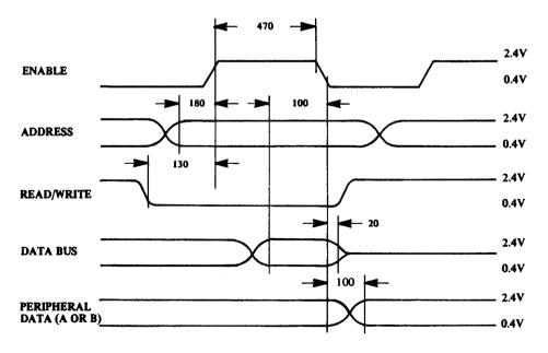
\*NOTE: ALL TIMES SPECIFIED ARE IN DSEC FOR 1MHZ OPERATION.
