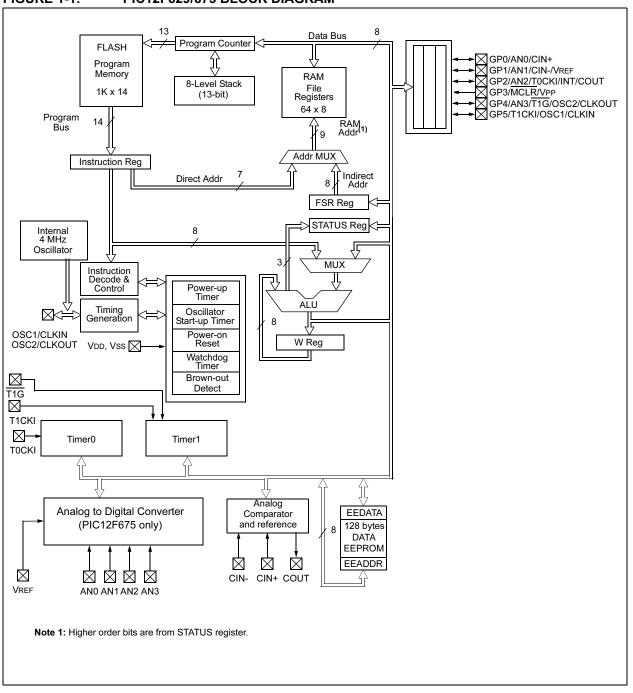
FIGURE 1-1: PIC12F629/675 BLOCK DIAGRAM
