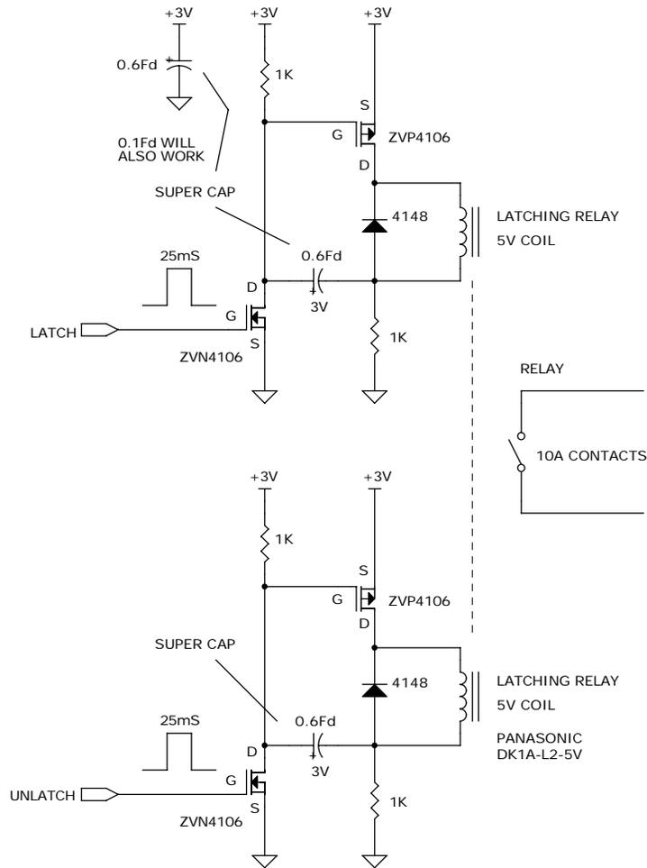
CIRCUITS ROUTE 6V PULSES INTO THE 5V RELAY FROM A 3V SUPPLY.
