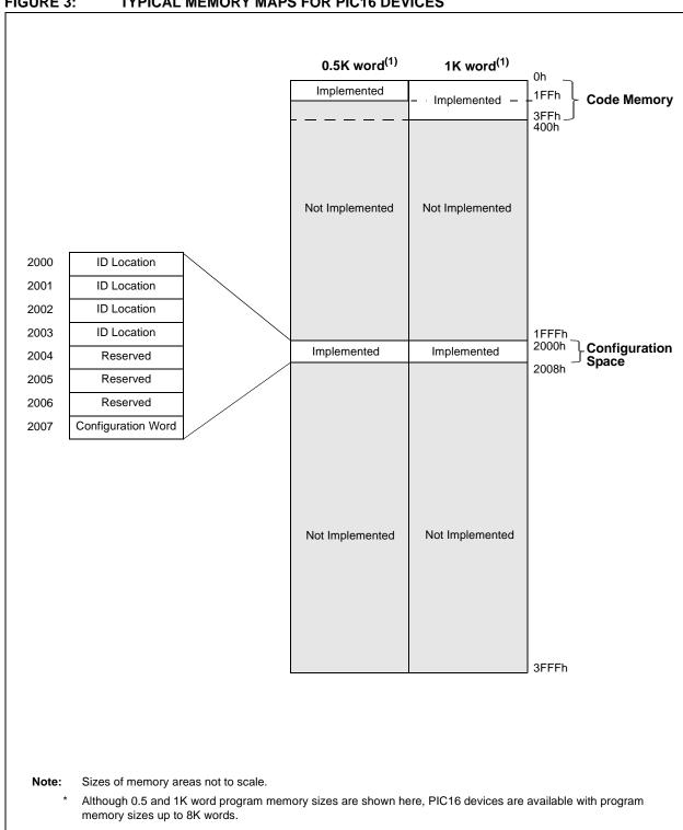
FIGURE 3: **TYPICAL MEMORY MAPS FOR PIC16 DEVICES**
