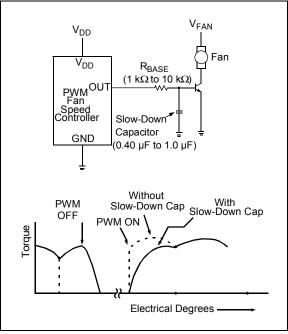
**FIGURE 4:** PWM Acoustic Noise Suppression Technique.
