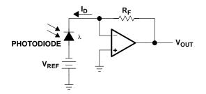
Figure 12-8. Photodiode Amplifier
