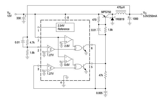
Figure 27. Step-Down Converter
