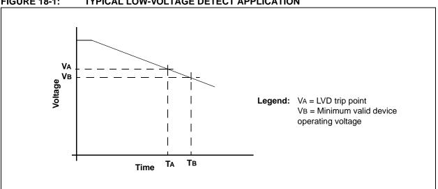
**FIGURE 18-1:** TYPICAL LOW-VOLTAGE DETECT APPLICATION
