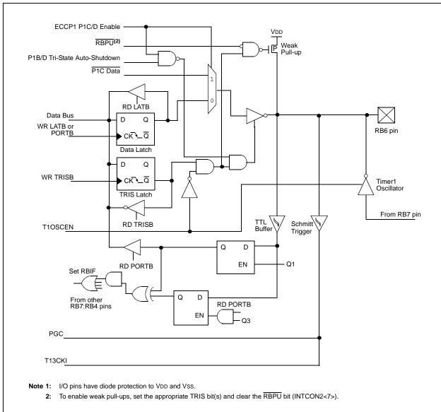
FIGURE 10-13: BLOCK DIAGRAM OF RB6/PGC/T10S0/T13CKI/P1C/KBI2 PIN
