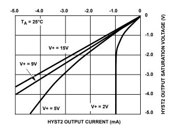
FIGURE 4. HYST2 OUTPUT SATURATION VOLTAGE vs
