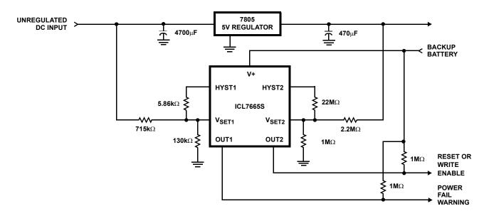
FIGURE 15. POWER FAIL WARNING AND POWERUP/POWERDOWN RESET
