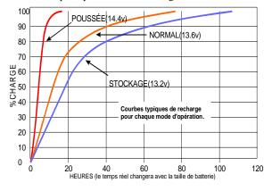
**14.4 Volts (Mode De Poussée)** A renvoyé la batterie à 90% de la pleine charge en approximativement 3 heures. La batterie a atteint la pleine charge en approximativement 11 heures.
