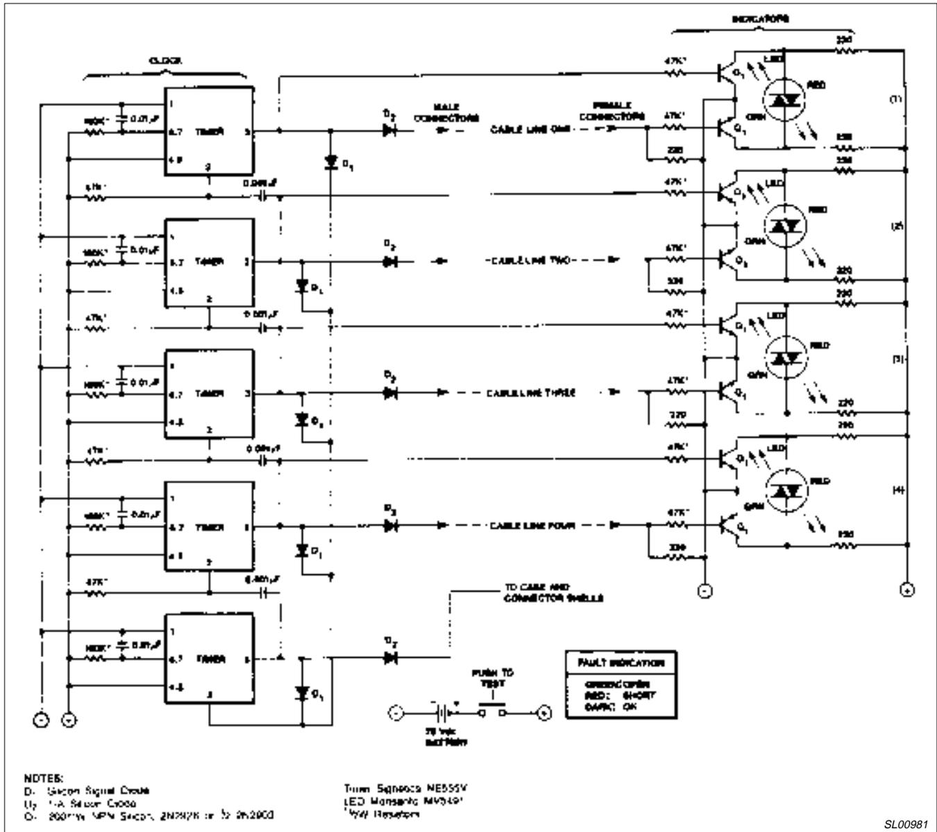
Figure 28. Cable Tester
