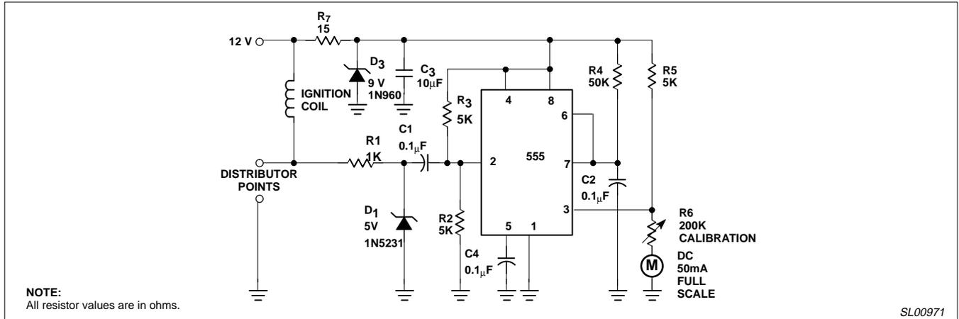
Figure 18. Tachometer
