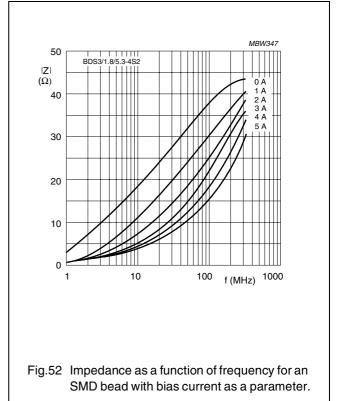
SMD FERRITE BEADS FOR COMMON-MODE INTERFERENCE SUPPRESSION
