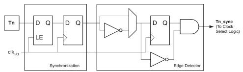
Figure 30. T1/T0 Pin Sampling
