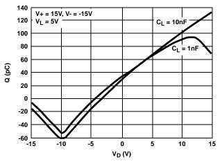
FIGURE 13. CHARGE INJECTION vs DRAIN VOLTAGE
