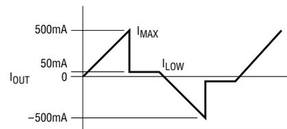
$$I_{MAX} \approx \frac{V_{CC} \cdot R_2}{(R_1 + R_2) \cdot 10 \cdot R_S}$$
