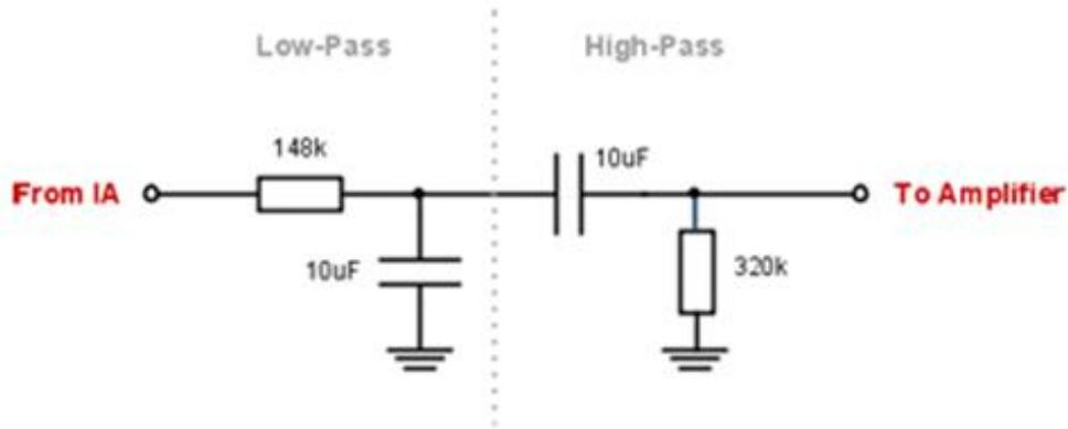
$$f_{c_{LP}} = \frac{1}{2\pi \cdot 148k\Omega \cdot 10\mu F} \approx 107 \text{ Hz}$$
