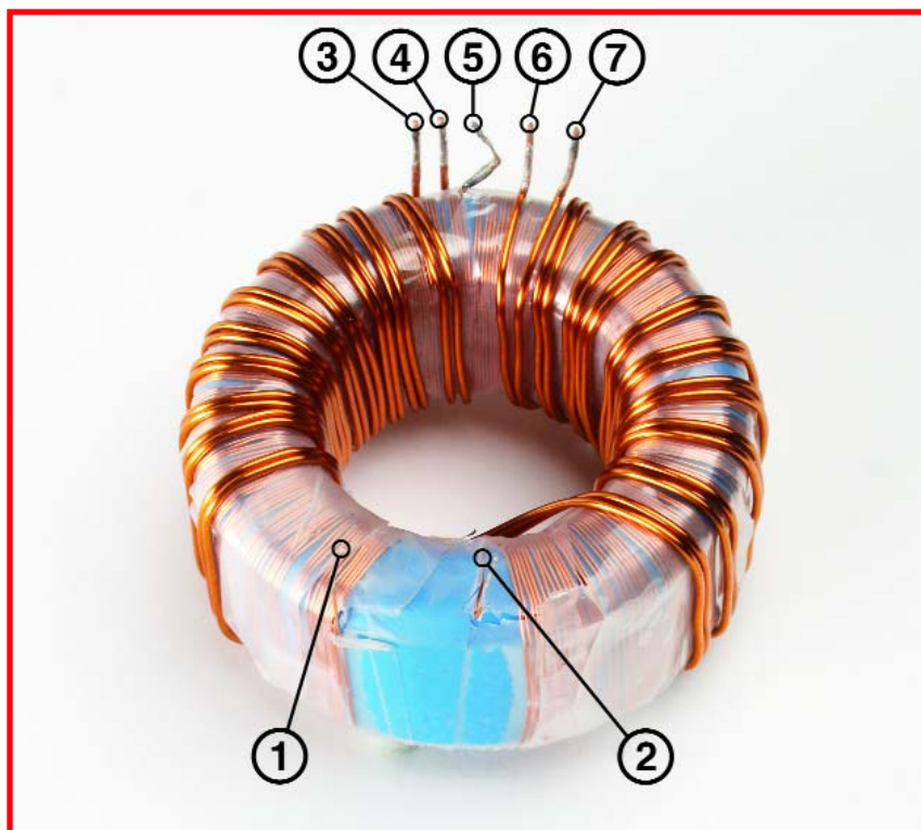
Bild 8. Hier kann man sehen, wie der Trafo gewickelt werden muss. Der Trafo auf dem Foto ist die Version 2.0 (das Foto am Artikelanfang zeigt die Version 3.0), aber das Wickelverfahren ist identisch. Erklärung der Anschlusspunkte: ① = C4 im Schaltbild, ② = C1, ③ = B2, ④ = A2, ⑤ = C2 und C3, ⑥ = B1 und ⑦ = A1.
