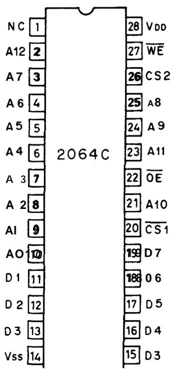
Figure A-7. 2064C Pin Diagram
