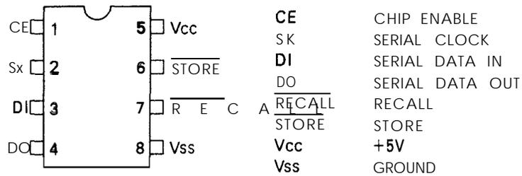
**Figure A-9. ER59256 Pin Diagram**
